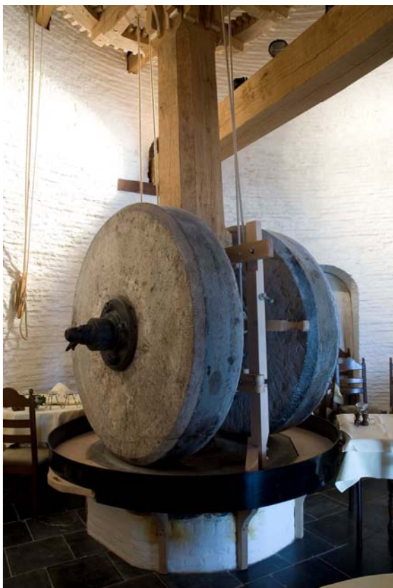
F 81: maalstenen om de olie te pletten
